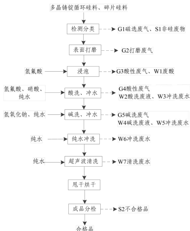
图 2-5 碎片硅料清洗工艺流程图
